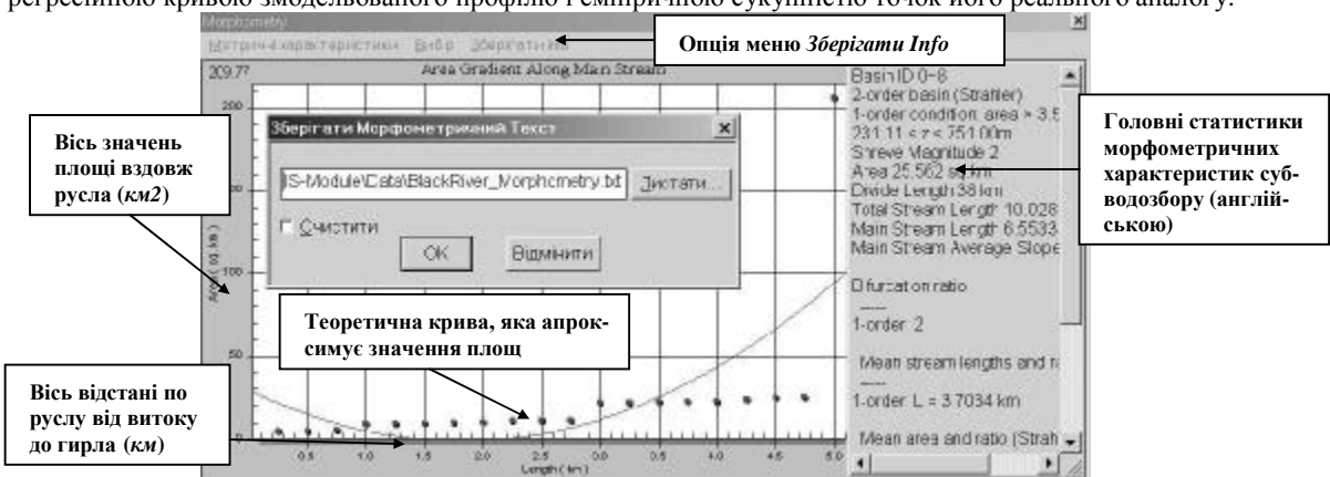
Рис. 6. Графік градієнту площі вздовж русла і діалог Зберегти Морфометричний Текст у вікні Морфометрія .
